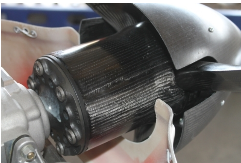
moyeu prolongé V12 monté sur le réducteur du moteur Rotax 912 ou 912S avec un cône
