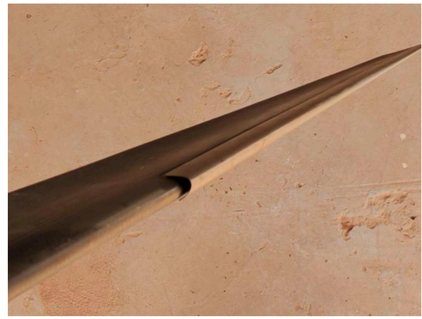
Fig. 2 – Détail du décollement de la protection de bord d'attaque
