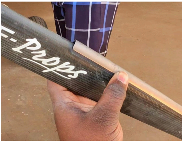
Fig. 1 – Pale avec décollement de la protection de bord d'attaque
