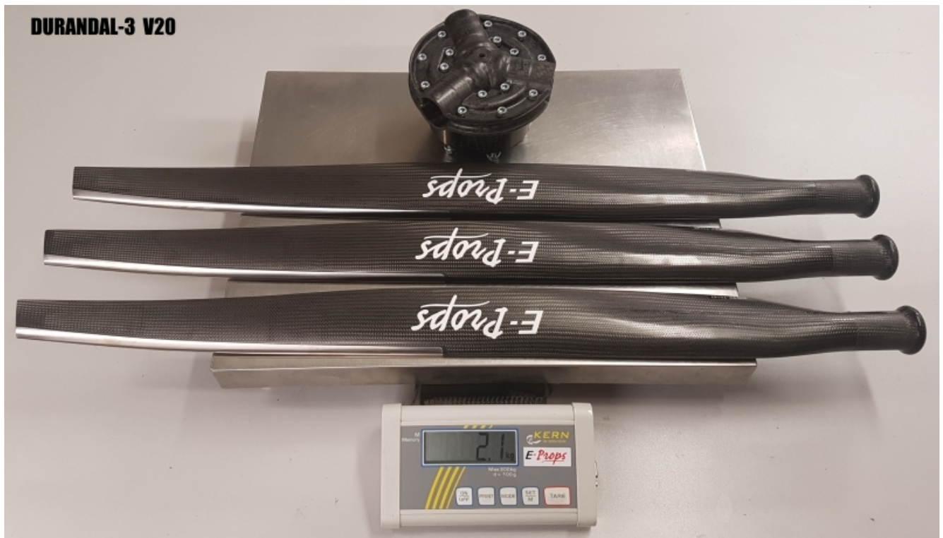
tripale DURANDAL-3 diamètre 170 cm, avec blindage Titane, avec toute la visserie = 2,1 kg
