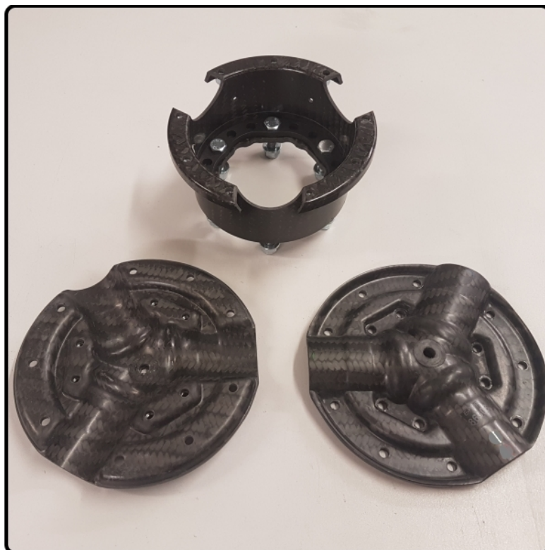
les 3 pièces qui composent l'ensemble moyeu - espaceur des hélices E-Props
