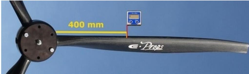
Astuce : quelques morceaux de scotch papier peuvent servir de repère à 400mm sur le bord du moyeu (ne pas oublier de les enlever avant le vol !).
