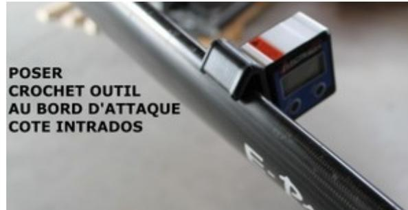
Les pales des hélices E-PROPS ont un bord d'attaque très galbé et un dièdre prononcé. Ces deux caractéristiques font que la mesure du pas doit être réalisée avec les pales exactement au même endroit.
