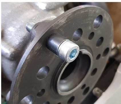
2 - Positionner l'extracteur sur le moyeu
