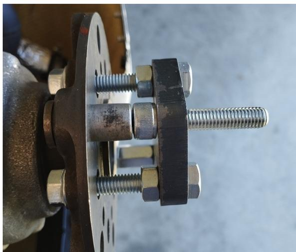
2 – Si l'extracteur se bloque avant que le pion ne soit libre, mettre l'écrou sous la tête de la vis M8 x 40.
