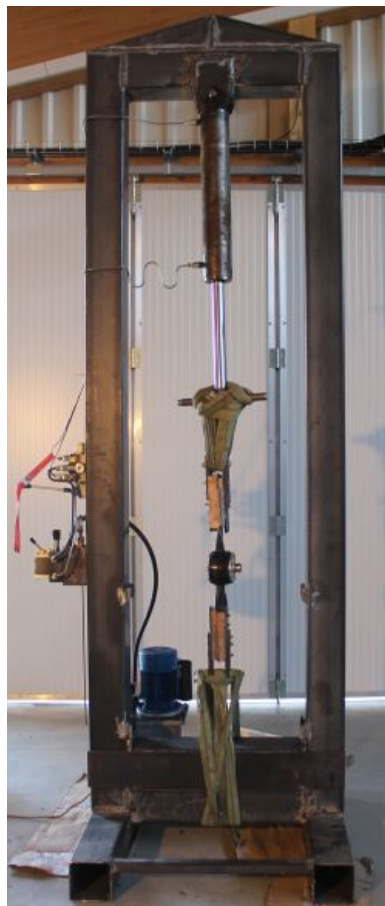
ensemble moyeu carbone + pale Vorpaline sur banc d'essais instrumenté
