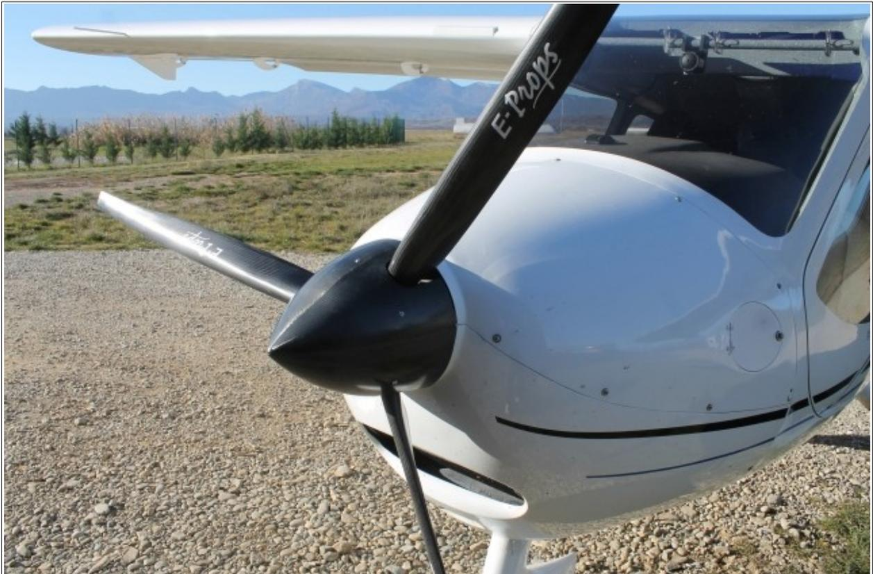
Un comparatif détaillé a été établi sur le CTLS équipé d'un Rotax 912S (100 cv) entre l'hélice tripale composite proposée en standard (NEUFORM 3-pales à pas réglable au sol diamètre 165 cm) et l'hélice E-Props DURANDAL 100-M (diamètres 165 ou 170 cm selon version de train d'atterrissage de CTLS).
